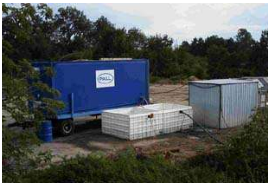
Рис. 2 - Мобильная пилотная установка для очистки сточных вод свалок ТБО. Пилотные установки PALL мобильны, абсолютно автономны (требуют только подключения электроэнергии) и могут быть предоставлены организациям в лизинг или с отсрочкой платежа.
