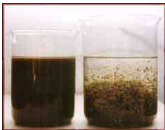
Кондиционирование шлама посредством полиэлектролита
